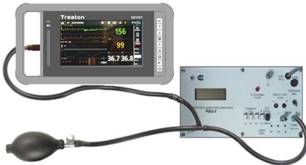
Рисунок 11.2 - Схема поверки диапазона и абсолютной погрешности измерений артериального давления в манжете
